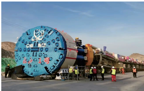
TBM整机（长约100米，直径7.03米）
