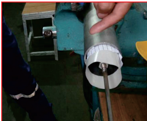
图 6.4 封头处粘贴水溶纸及胶带
