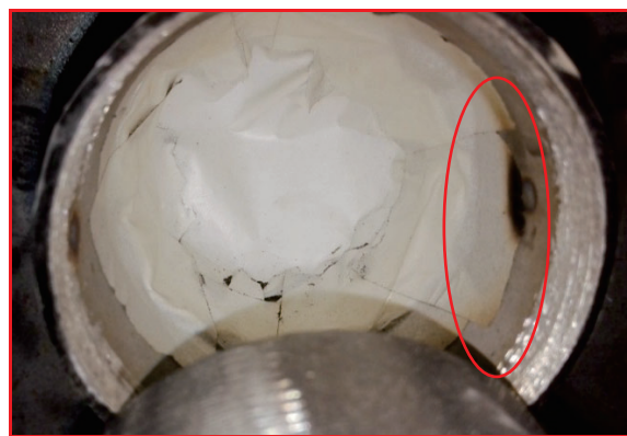
图5 焊接高温烧焦的水溶纸
